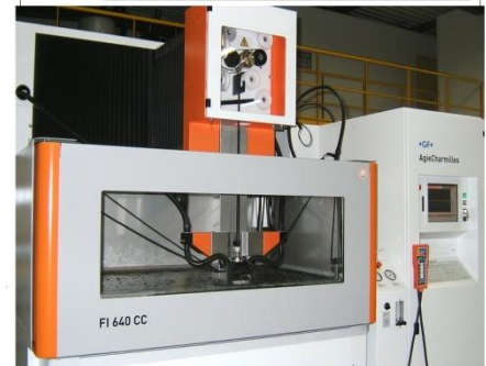
Électro-érosion fil - Hauteur Coupe Maxi = 510 mm
